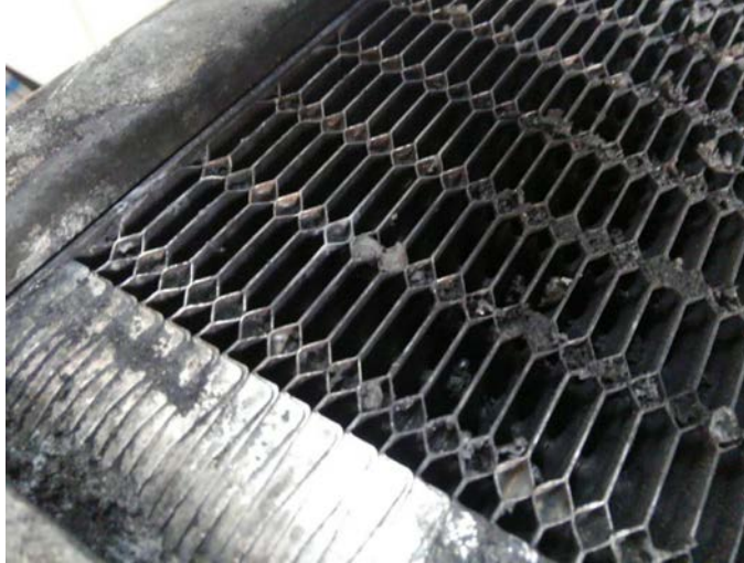
写真8：写真7の拡大。少し銅色が確認できるが、大量のススが表面に堆積している
