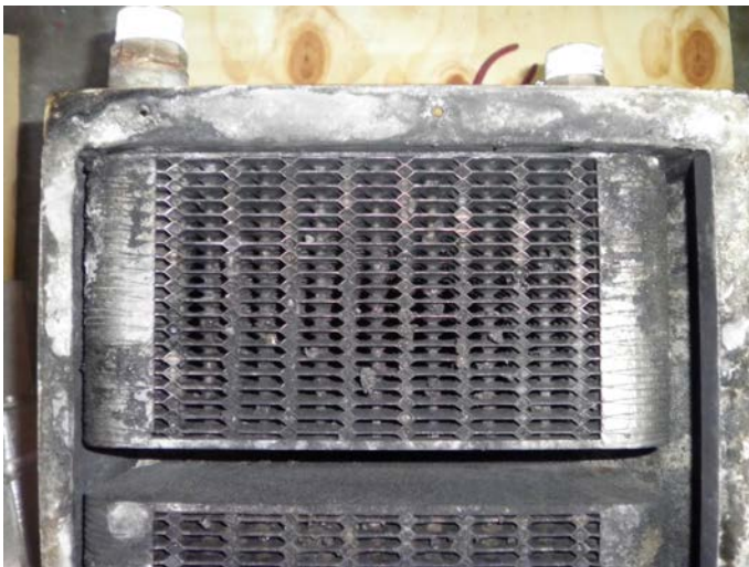
写真4：試験終了後の銅ロウ付プレート熱交換器 本体への硫酸水による腐食原因による孔食ピンホールは 確認できなかった。ススの堆積は非常に多いが 通風経路は閉塞しておらず、熱交換を維持していると思 われる
