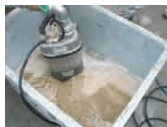
ダイナミックデスクリーンの泡で、有機物 や固形物も発泡によって吹き飛ばされ 排出される。
