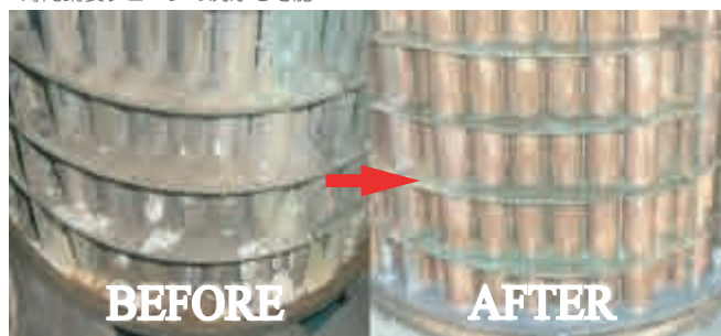
内径800mm、全長5mの熱交換器 処理時間は、最大で5時間以内(従来製品では8時間-12時間以上)
