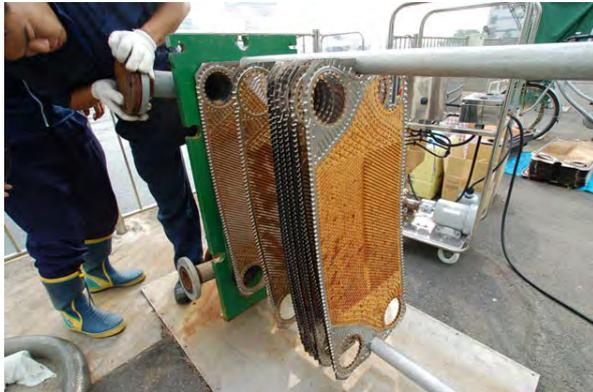
ALFALAVAL M10M TITAN/NBR 海水側を循環洗浄にて実験開始
