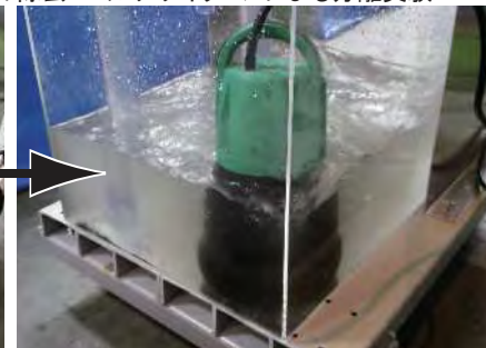
宮崎県 クーリングタワー混入火山灰(40 \mu )の除去 マルチサイクロンによる分離実験
