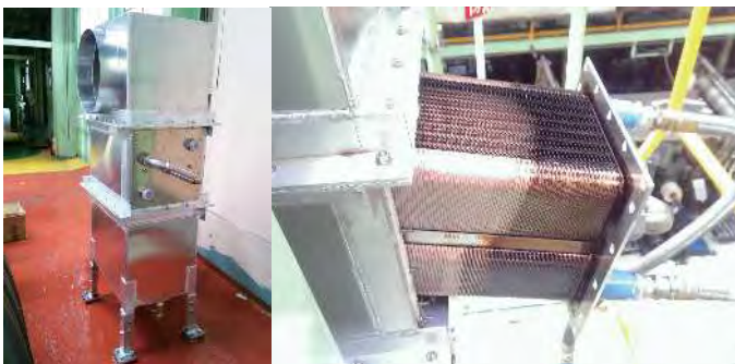
東京都 大手鉄工メーカー様 油煙＋排気ガス熱回収
