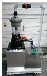
マルチサイクロン12 デモユニット 鹿児島県桜島火山灰の 分離テスト状況
