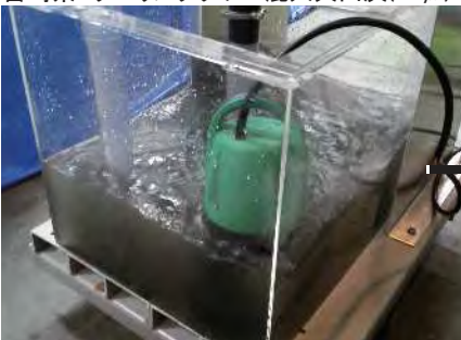
宮崎県 クーリングタワー混入火山灰(40 \mu )の除去 マルチサイクロンによる分離実験
