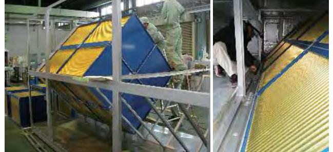
東京都内 大型病院様 換気排熱回収
